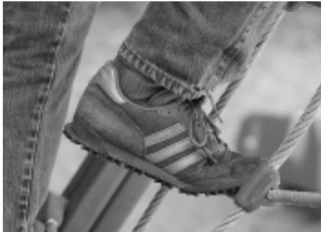
Foto 6: Ein Mitarbeiter prüft die Belastbarkeit der Seilverbindungen eines Klettergerüsts im Kindergarten
